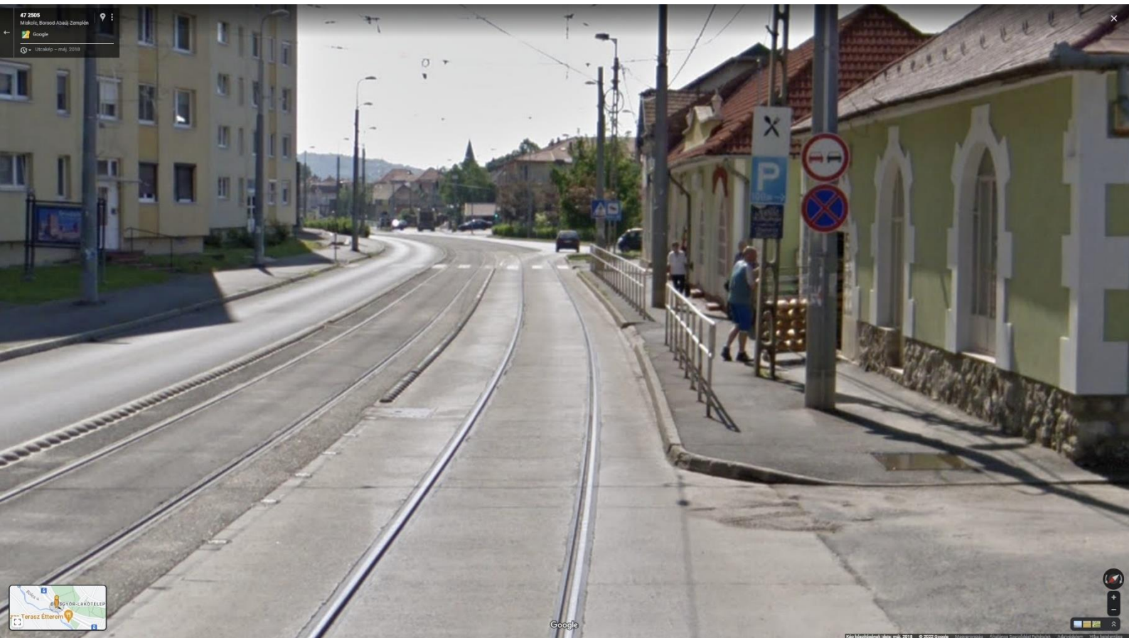
132. ábra. A kerékpározó szekunder pozíciójában húzódo sínszál
